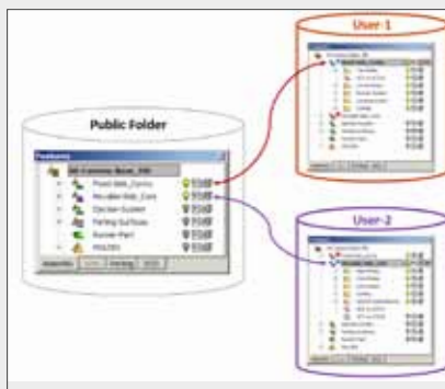
Lo schema mostra due utenti al lavoro contemporaneamente sullo stesso progetto ed evidenzia il controllo sui relativi componenti
